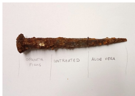
Fig. 4. Iron nail treated with OFI cladodes and AV extracts
