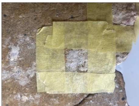
Fig. 8. EDTA cleaning test
