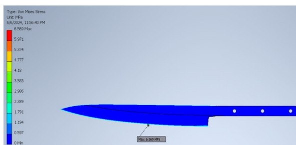
Fig. 21. Von Mises Stress ( F = 25\text{N} )
